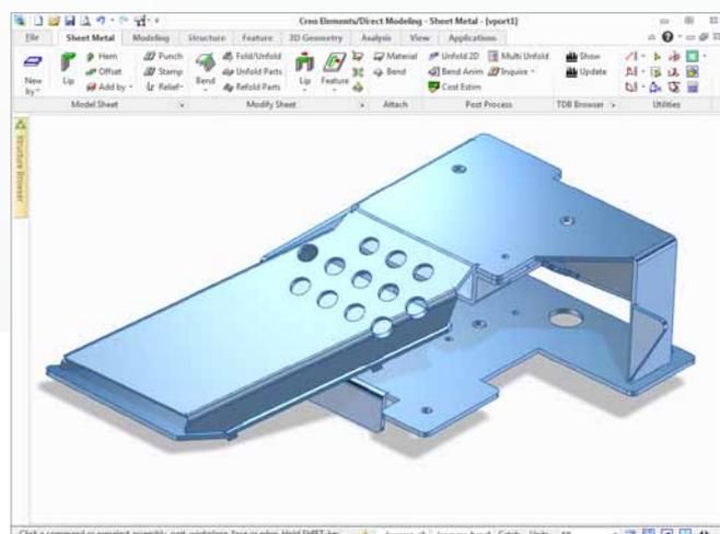
Blechteile können mit [Creo Elements/Direct Sheet Metal](#) ganz einfach auf- und abgewickelt werden.
